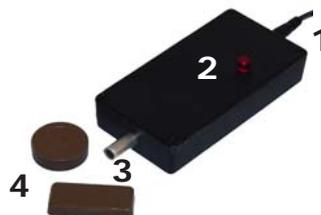
(1) Connettore a di alimentazione: Deve essere attaccato ad un alimentatore da 12 V 100 mA. Positivo sulla punta del jack..
